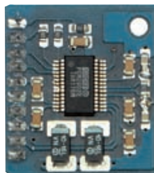
Fig.5 Ecco come si presenta il circuito KM1667 contenente il convertitore USB PCM2902, visto dal lato componenti.
