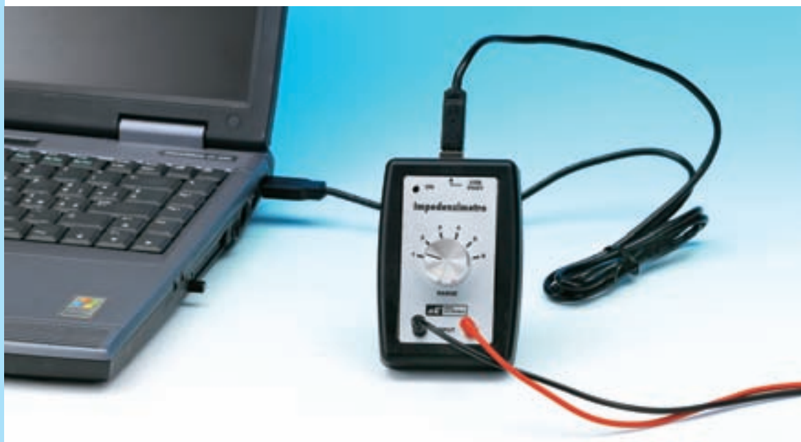
Fig.9 Nella fotografia è visibile il commutatore S1 che permette di selezionare le 5 diverse portate dello strumento. Per evitare errori di misura occorre verificare che la posizione del commutatore coincida sempre con il numero riportato alla voce corrispondente del software operativo.
