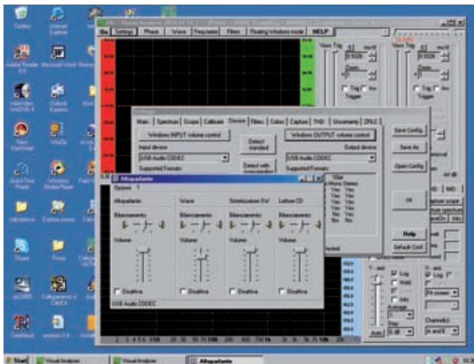
Fig.8 Qualora durante la misura dell'impedenza non comparisse sullo schermo il segnale sinusoidale, occorre controllare che la regolazione mixer di Windows sia correttamente impostata. Per farlo, cliccate sull'opzione Settings della finestra principale. Sulla finestra che si apre selezionate l'opzione Device. Dopo aver fatto il riconoscimento della scheda USB Audio Codec, cliccate sulla opzione "Windows OUPUT volume control" e verificate che il potenziometro di regolazione dell'Altoparlante sia posizionato al massimo, cioè tutto verso l'alto, e che la casella sottostante con la scritta Disattiva non sia spuntata.
